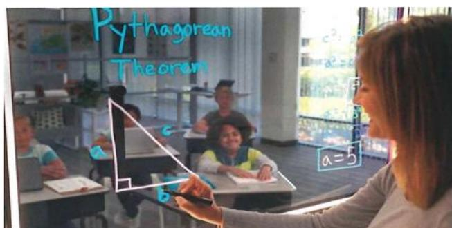
内蔵カメラが顔と文字を同じフレームに合成キャプチャし、画像を反転してテキストが正しく読めるようにします。
